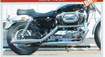
Wie schon in unserem Auspufftest für Softails in Ausgabe 6/02 machen die Slip-on-Dämpfer von AMC auch dieses Mal wieder eine sehr gute Figur. Auspacken, dranschrauben (ein Kinderspiel dank hervorragender Paßgenauigkeit) und losballern mit mehr Druck und Power. Zweifelsfrei toll im Sound, bringen die AMC-Tüten mit ihren von uns gemessenen 99 dB(A) Standgeräusch aber sicherlich die Stirnfalten von so manchem Polizisten zum Runzeln.
