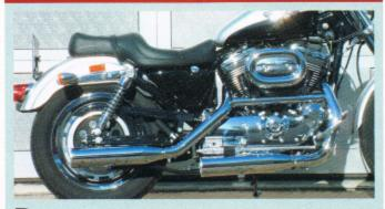
ie Eagle Slip-on-Dämpfer von Speed Products sind die günstigste Alternative in unserem Test. Der Anbau ist auch von weniger geübten Schraubern recht schnell zu erledigen. Die Paßgenauigkeit ist ordentlich, lediglich der Innendurchmesser der geschlitzten Anschlußteile an den Dämpfem ist etwas zu groß. Da müssen die Schellen viel Klemmarbeit verrichten, sonst zischelt's undichterweise. 3,1 PS auf die Serienleistung fehlten, was aber nicht die Welt und deswegen für viele Fahrer verschmerzbar ist.
